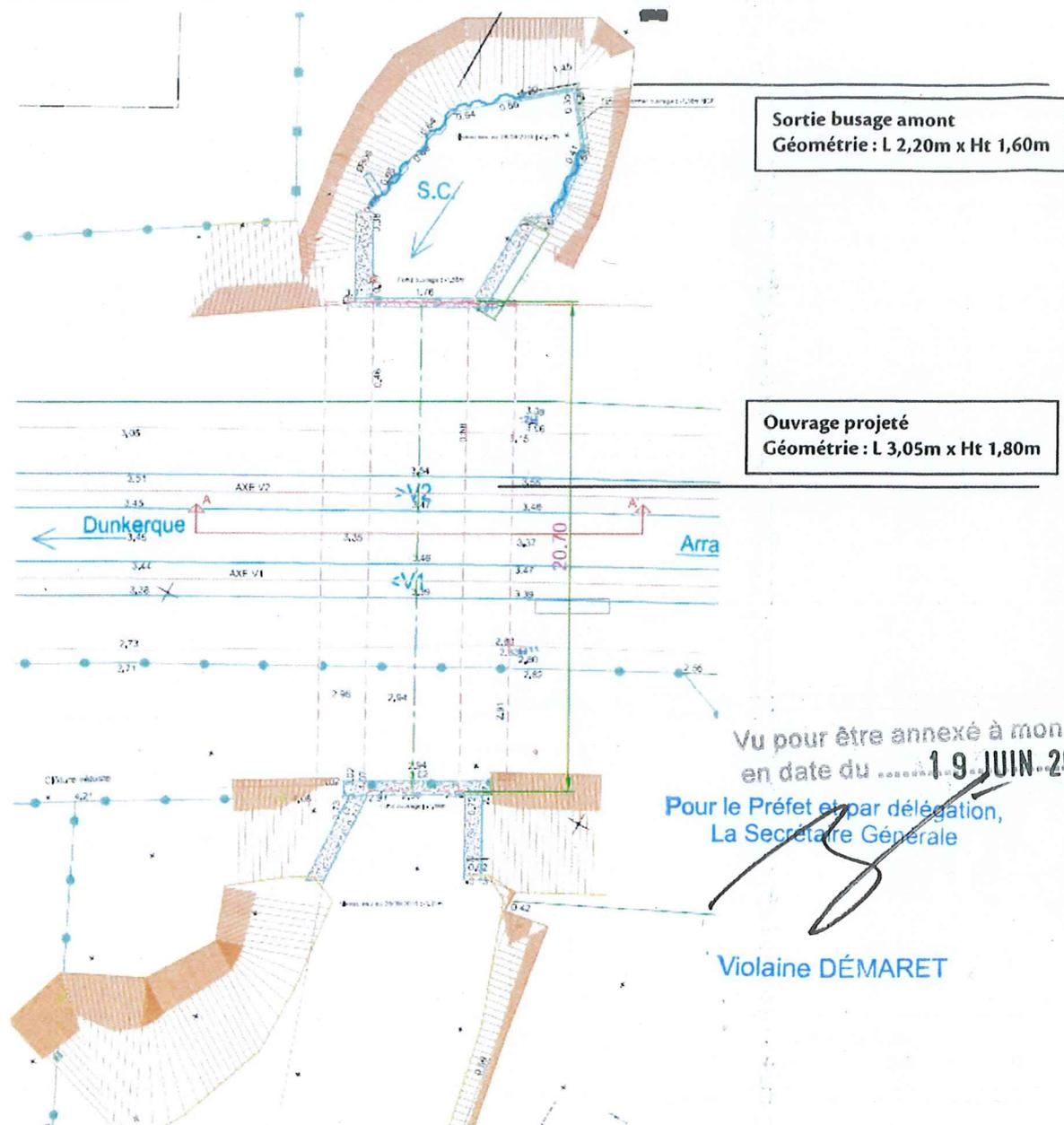
**Le débit capable de l'ouvrage projeté est de 22,62 m<sup>3</sup>/s (>> débit centennal du cours d'eau d'environ 5,7 m<sup>3</sup>/s)**
